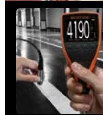
Le nouvel Elcometer 500 peut mesurer rapidement, précisément et avec répétabilité l'épaisseur de film sec sur béton et autres substrats cimenteux.
